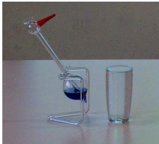
Inizialmente si scalda con la mano il liquido contenuto nella pancia del papero, la tensione di vapore nella testa diventa inferiore della tensione di vapore che si ha in basso, e il liquido risale entro il collo.
