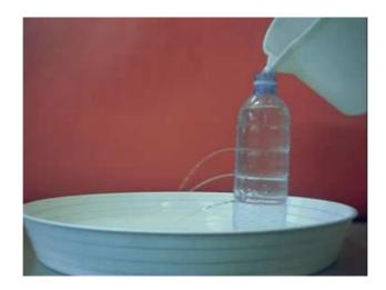
Quando il tappo è chiuso e i fori sono opportunamente di piccolo diametro, è la pressione atmosferica che impedisce all'acqua di zampillare, svitando il tappo invece questa pressione agisce sia sui fori laterali sia sull'acqua che si trova in alto, in quanto la pressione atmosferica, contrariamente a ciò che si può pensare, agisce egualmente in ogni direzione, ad altezza circa costante.
